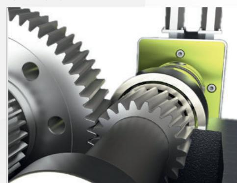
反向间隙检测
